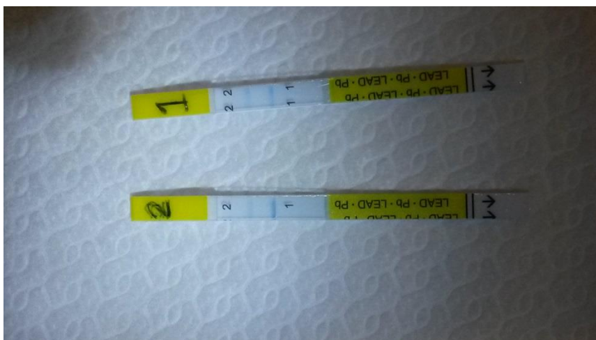
FIGUUR 18. VOORBEELD VAN EEN DOOR DEELNEMER OPGESTUURDE FOTO VAN DE INDICATIESTRIPS. IN DEZE FOTO IS STRIP 1 POSITIEF, OMDAT HET STREEPJE RECHTS VAN '2 2' ONGEVEER EVEN DONKER IS ALS HET STREEPJE LINKS VAN '1 1'. STRIP 2 IS NEGATIEF, OMDAT HET STREEPJE RECHTS VAN '2' LICHTER IS DAN HET STREEPJE LINKS VAN '1'
